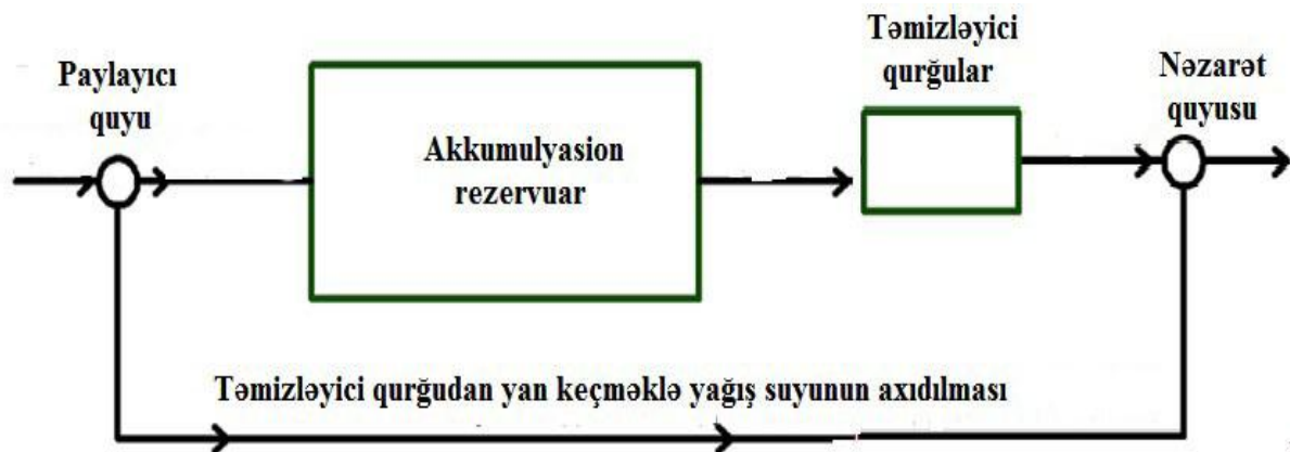
Şəkil 3. Yağış sularının alternative su mənbəsi kimi istifadəsinin sxemi
