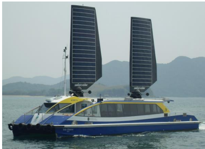
Şəkil 1. "Solar Albatross" gəmisinin günəş enerjisi icrası
